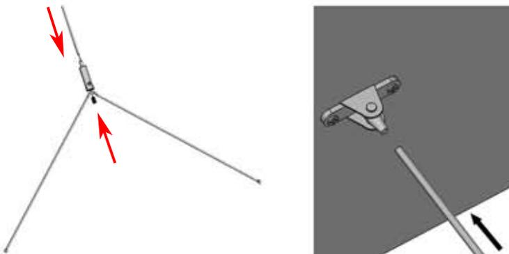
**9.** DC Leitung & ggf. Seil durch die Baldachinöffnung führen und anschließend die Baldachinabdeckung mit Hilfe der Hutmutter und der Fächerscheiben befestigen.
