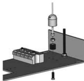
**5.** Befestigen der Abhängungssysteme und des Baldachins mit Hilfe von geeigneten Montagematerials (nicht enthalten) für die vorliegenden Deckenbeschaffenheiten.
