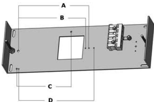
**4.** Baldachin für die zu verwendene Seilab-hängungs Montage vorbereiten
