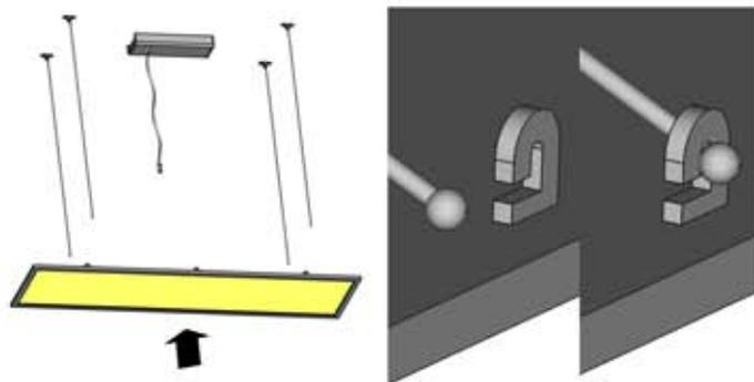
**11.** Ein Ausrichten der Pendelleuchte ist mit einem Druck auf die Seilbefestigungssysteme zum lösen der internen Verriegelung leicht möglich. Anschließend die überschüssige Seillänge abtrennen.
