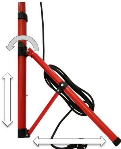
Die Füße können durch lösen der Fixierschraube und anschließendes Herunterdrücken des Mittelteiles ausgefahren werden. Anschließend Fixierschraube festdrehen. Ein Einfahren der Füße ist in umgekehrter Reihenfolge möglich.
