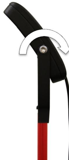
Das Schwenken des Flutlichtstrahlers ist durch die seitlich angebrachten Schrauben möglich. Diese sollten so eingestellt sein, dass ein gewisser Klemmdruck den Strahler in Position hält.
