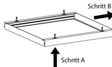
Vormontierten Anbaurahmen über die Schraubenköpfe führen, seitlich verschieben und Schrauben komplett anziehen
