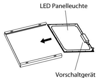
Vorschaltgerät verdrahten und Leuchte einschieben
