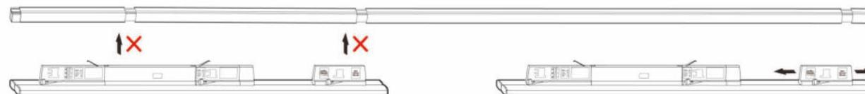
Wenn die Schienenverbindung **12** die Position der Befestigungssperre **9** beeinträchtigt, befolgen Sie die Anweisungen von Schritt 1.
