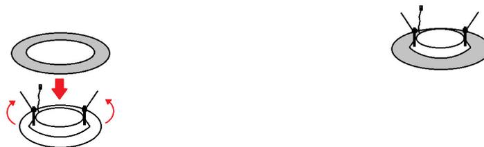
5. Kontaktierung der DC-Leitung von Leuchte und Vorschaltgerät durchführen. Anschließend Leuchte in Deckenöffnung und Einrührstrahmen einführen.
