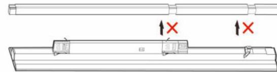
Wenn die Schienenverbindung **12** die Position der Befestigungssperre **9** beeinträchtigt, befolgen Sie die Anweisungen von Schritt 1.
