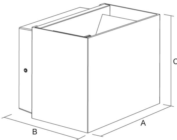
Der Lichtaustrittswinkel beider Seiten ist unabhängig voneinander zwischen 15° bis 120° per Handverstellung der Metallflügel einstellbar!
